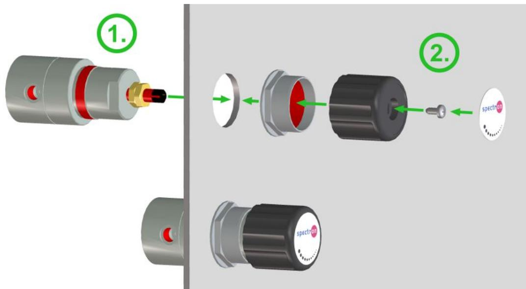
3: Montaggio a pannello riduttore di pressione serie 50
