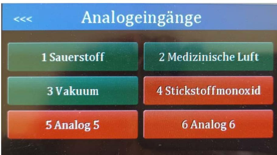
Die Konfiguration der Analogeingänge ist in drei Bildschirme unterteilt. Auf dem ersten können Sie den Namen des Gases ändern, den Eingang aktivieren oder deaktivieren, die Maßeinheit, die Art des Speichers, die Aktivierungsverzögerung, die Farbe der entsprechenden Taste und den Ton des Alarms ändern.
