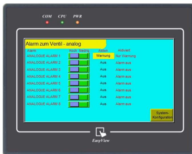
**Bildschirm Analoge Alarm-Konfiguration mit eingerichteten Alarmzuständen (Beispiel)**
