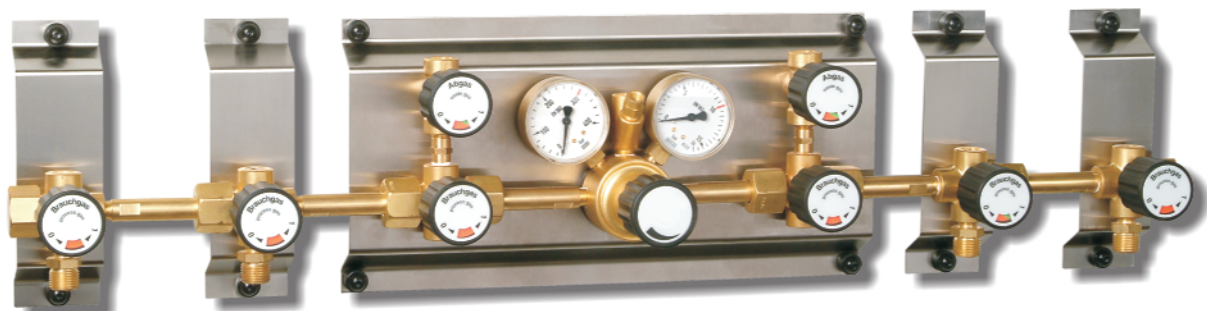
BT2000-2X2, Centrale de détente avec un inversion manuelle assemblé avec 2 extensions individuelles
